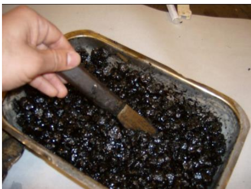
Figuur 1 Terugwinning van mastiek met behulp van een spatel
