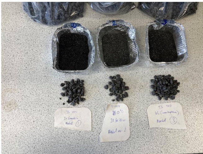
Figuur 3 Drie gegranuleerde en gezeefde speciemonsters
