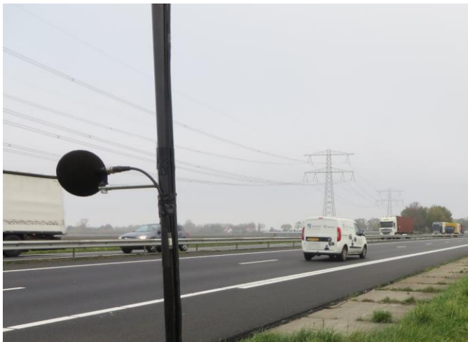
figuur 1 Met SPB-methode [1] worden de geluideigenschappen van het wegdek vastgelegd. De methode C_{\text{wegdek}} beschrijft hoe op basis van meerdere SPB-metingen een wegdekcorrectie kan worden bepaald.
