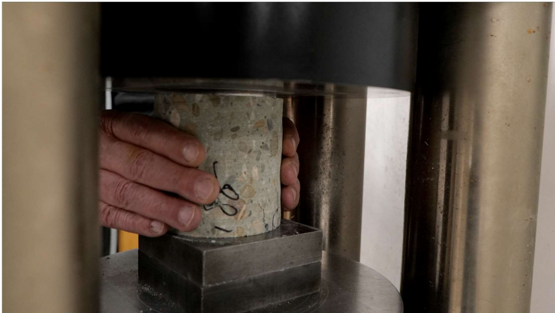
Figuur 3: Betonkern wordt beproefd in het laboratorium van Nebest
