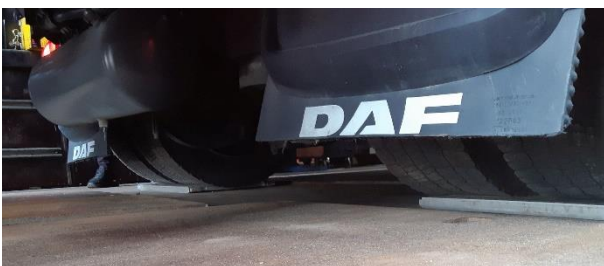
Figuur 6: Positionering dubbellucht wielen op weegplaten
