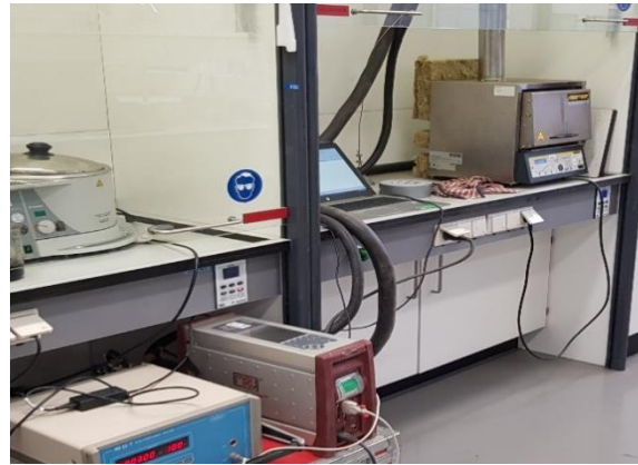
Figuur 4: Proefopstelling emissiemetingen
