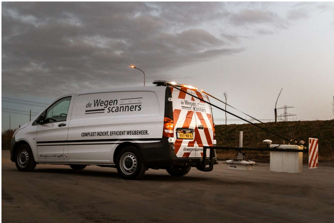
Figuur 1 Wegenscanners meetbus in actie (rijdend scannen)
