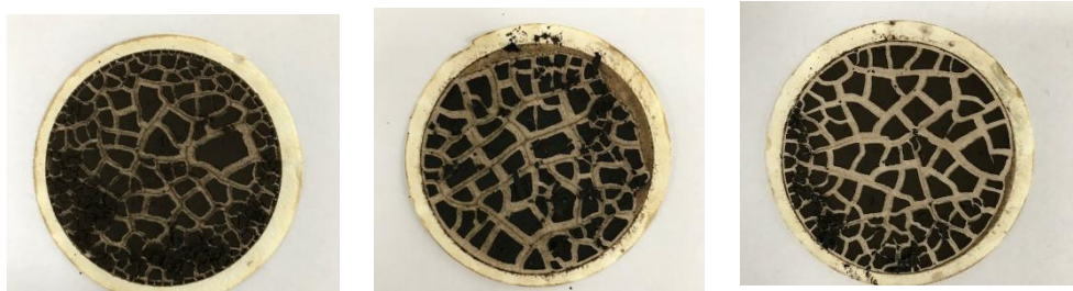
Bitumen 70/100 (links) en 160/220 (midden) uit 2020 en 160/220 (rechts) uit 2021.
