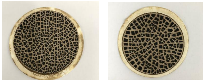
Bitumen 70/100 (links) en 160/220 (rechts) uit 2020.
