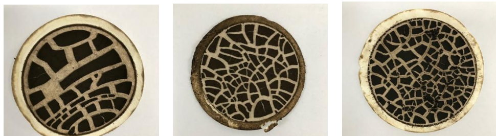
Bitumen 70/100 (links en midden) uit 2020 en 160/220 (rechts) uit 2021.
